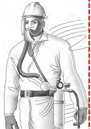
全罩式輸氣管呼吸防護具 (SAR) APF = 1,000
