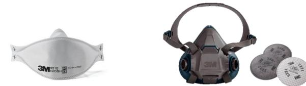
Step 2. 評估氣態汙染物之HR皆小於1, 低於容許暴露濃度. Nickel 之HR 為1.2, 可選用PF10的粒狀汙染物防護具如N95等級口罩或半面體+N95等級濾棉即可.
